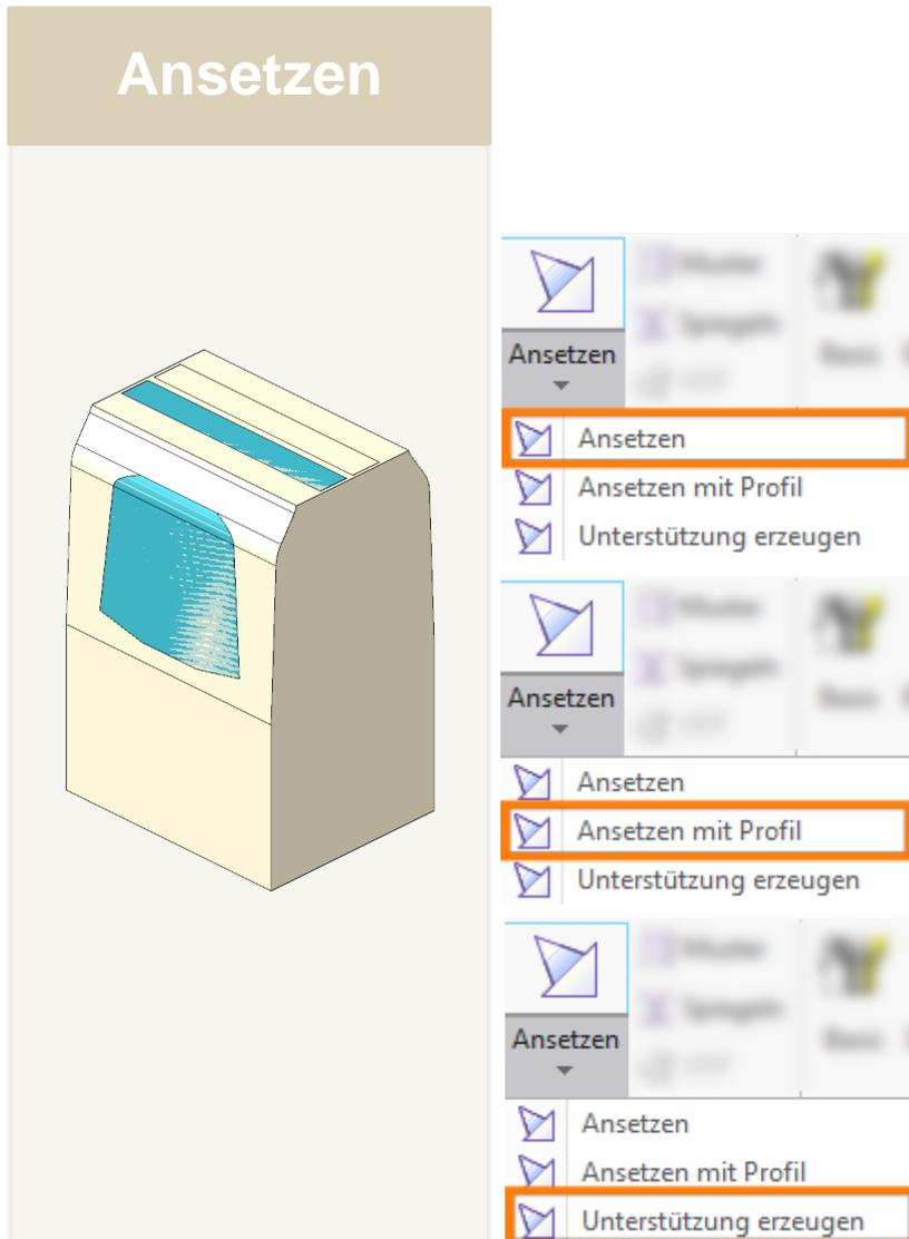
**Beim Ansetzen wird die Geometrie mit der späteren Basis verbunden.**
